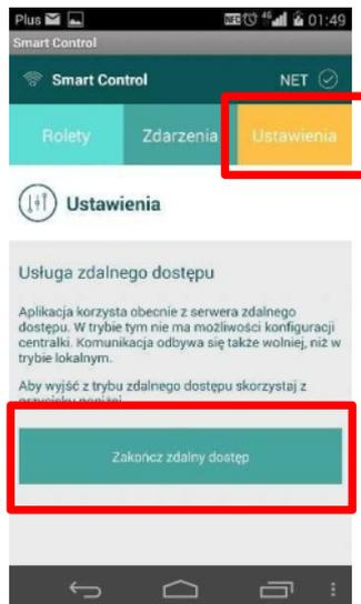
Die Fernsteuerung charakterisiert sich wegen der Verwendung des Vermittlungsservers durch eine längere Wirkungsdauer im Vergleich zum lokalen WLAN. Wenn Sie sich wieder im lokalen Netz befinden, können Sie durch die Option „Einstellungen“ und das klicken auf „Beenden“ mit dem lokalen Netz verbunden werden.
