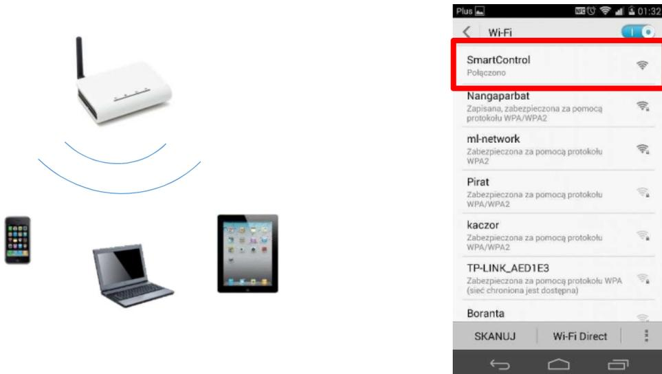
Nach dem anschließen der Zentrale und der abgeschlossenen Initialisierung, bietet das Gerät standardmäßig sein eigenes WLAN unter dem Namen „SmartControl“ zu Verfügung. Mit Hilfe eines mobilen Geräts (Smartphone oder Tablets) öffnen Sie die W-LAN Einstellungen und überprüfen die verfügbaren Netzwerke. Es zeigt sich das ungesicherte SmartControl Netzwerk, an das Sie sich anschließen.
